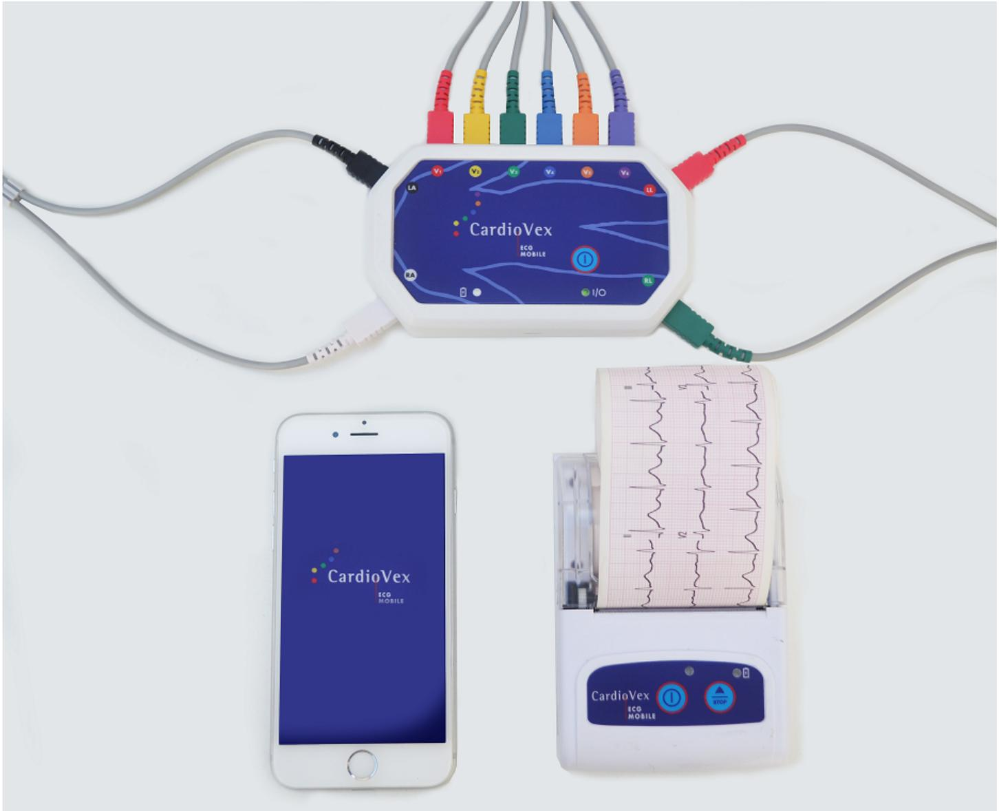
*Figura 2. Conexiones del equipo CardioVex ECG Mobile*
